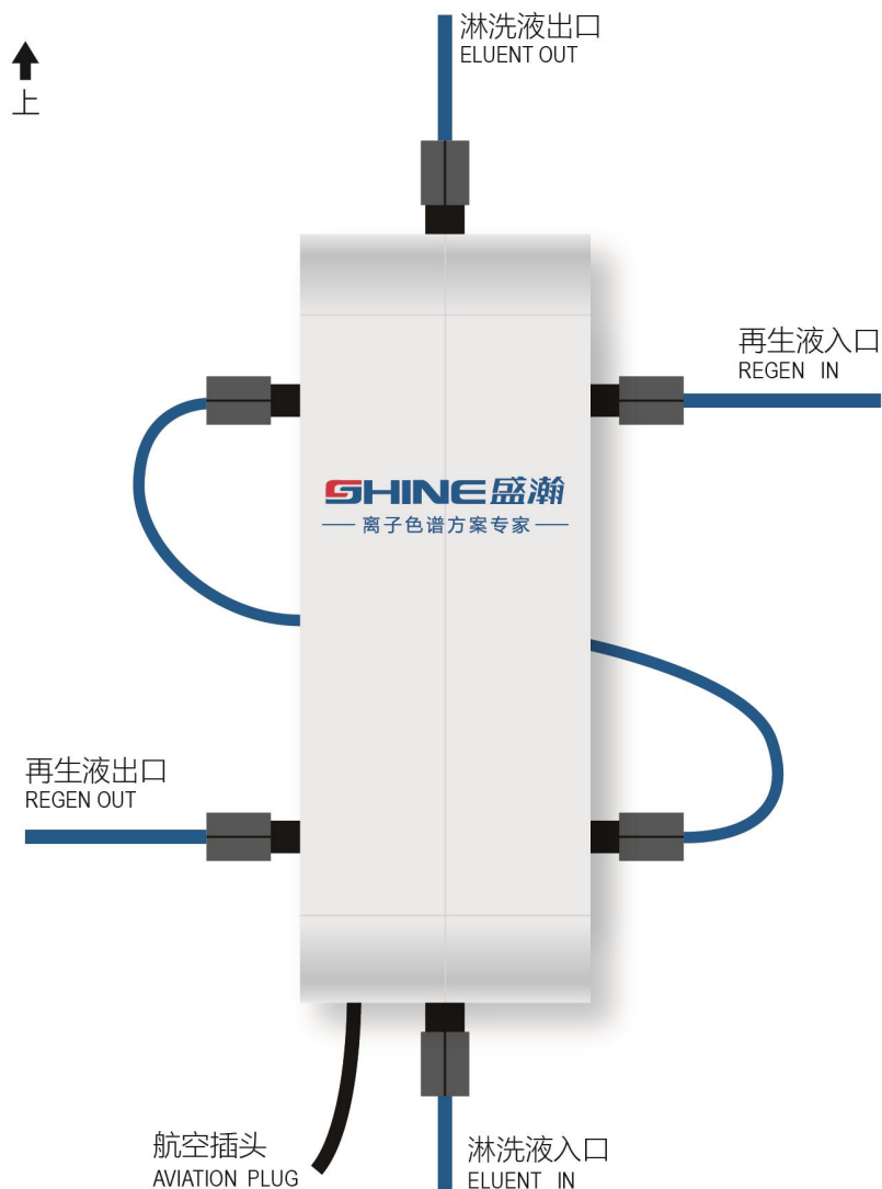
— 抑制器正面管路连接图 —
